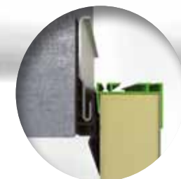
En partie haute, U en polythermalyste collé et popé assurant la rupture de pont thermique entre l'extérieur et l'intérieur
